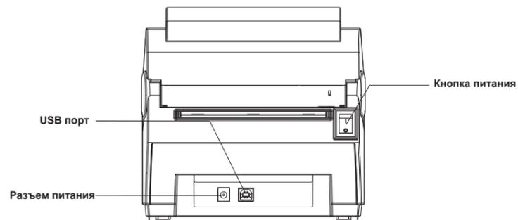
**Устройство печатающего блока**
